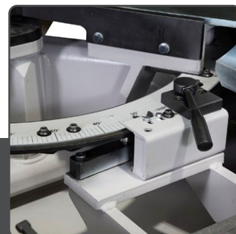
Possibilità di taglio a 60° destra / sinistra. Mitre cutting up to 60° right/left.
