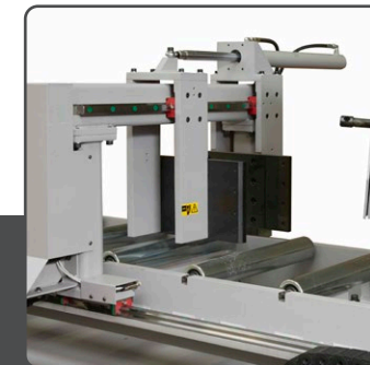
Carro avanzatore con rulliera integrata per un perfetto supporto del materiale Roller table integrated on the feeder to support the material completely
